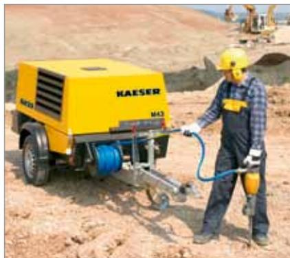
Производительность от 2 до 5,6 м³/мин не позволяет этим моделям серии MOBILAIR быстро «замерзнуть»: запатентованная защита от обледенения автоматически согласует рабочую температуру установки с окружающей температурой. Таким образом, пневмоинструменты защищены от замерзания, что обуславливает их повышенную надежность и долговечность.
